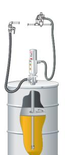
Kit bomba neumática PumpMaster 4 ratio 5:1 para transvase de grasa a media presión desde bidones originales de 185 Kg. Presión máxima de aire: 10 bar. Caudal máximo grasa: 7 Kg./min. (NLGI-2 a 20°C). Presión máxima del fluido: 50 bar. Longitud manguera salida: 1,5 m.
