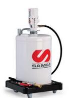
Unidad móvil provista de bomba neumática especial a baja presión PumpMaster 3 ratio 2:1. Fijada en la tapa del carenado de protección permitiendo la utilización del equipo con cualquier bidón original de grasa de hasta 20 Kg. Caudal max. grasa: 2 Kg./min. (NLGI-00 a 20°C). Presión max: 20 bar.
